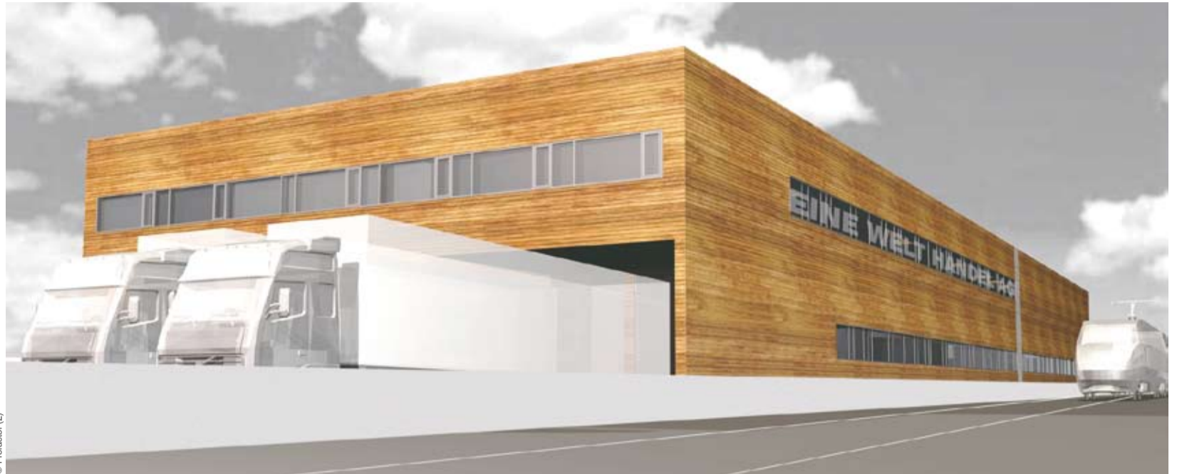
Dieses eco 2 building in Holzfertigteilbauweise spart bei konkurrenzfähigen Baukosten bis zu 90 Prozent der anfallenden Heizkosten.
